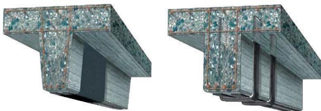
Рис. 2. Усиление балок с применением углеволокна
