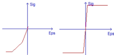
Рис. 2. Кусочно-линейные диаграммы деформирования материалов конструкций балок: бетона (слева) и арматурных элементов (стальной зубчатой ленты, стержней) (справа)
