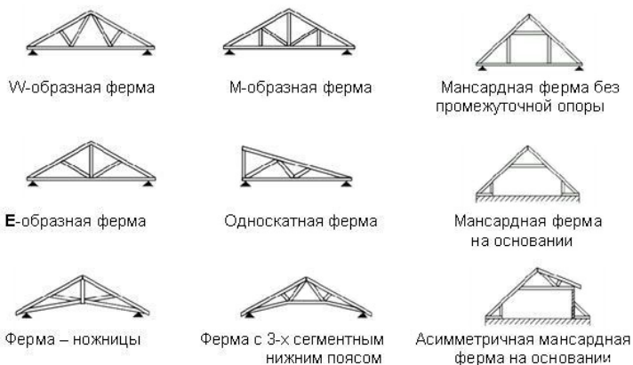
Рис. 1 Виды строительных ферм, основанные на треугольной форме.
