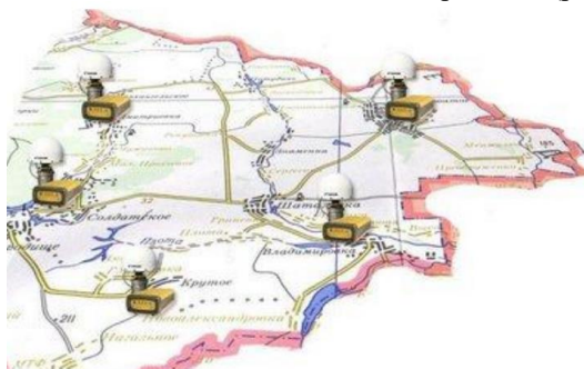
Рис. 2 Пример региональной схемы расположения базовых станций ГНСС
