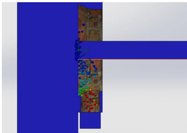
Рис. 4 Визуализация локализации пыли имеющей максимальный диаметр 300 мкм.
