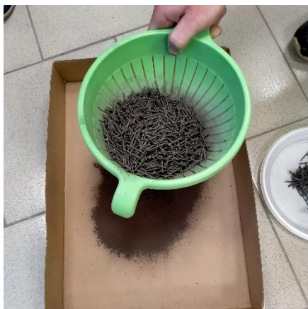
Рис. 4 Процесс пропуска материала через сито
