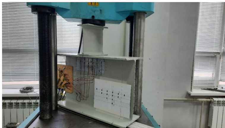
Рис. 1 Опытный образец (двутавр) в универсальной гидравлической испытательной машине WEW-600.
