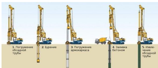
Рис. 2 Процесс изготовления буровых опор большого диаметра.
