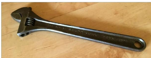
Рис. 5 Классический (Шведский) ключ
