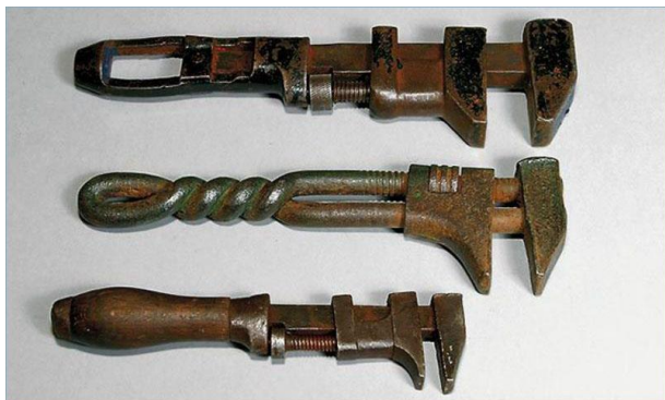
Рис. 3 Разводные ключи с переставляемыми «губками»
