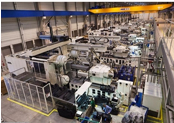
Рис. 2. Шнековые машины для выпуска реакто- и термопластов
