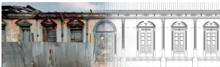
Рис.4. Переход между фотографией и BIM-моделью Rey Prendes House
