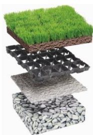
Рис. 3 Устройство экологической парковки (снизу-вверх): гравий, песок, армирующая сетка, грунт с газонным покрытием.
