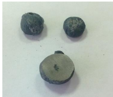
Металлические слитки полученные из пылевидных металлсодержащих отходов
