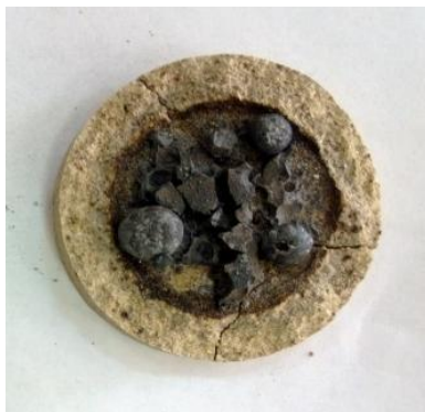
Металлические слитки полученные из пылевидных металлсодержащих отходов
