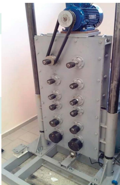
Вибрационный стенд для получения асимметричных колебаний
