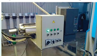
Установка для сверхтонкого измельчения материалов во вращающемся электромагнитном поле.
