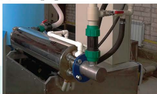
Установка для сверхтонкого измельчения материалов во вращающемся электромагнитном поле.
