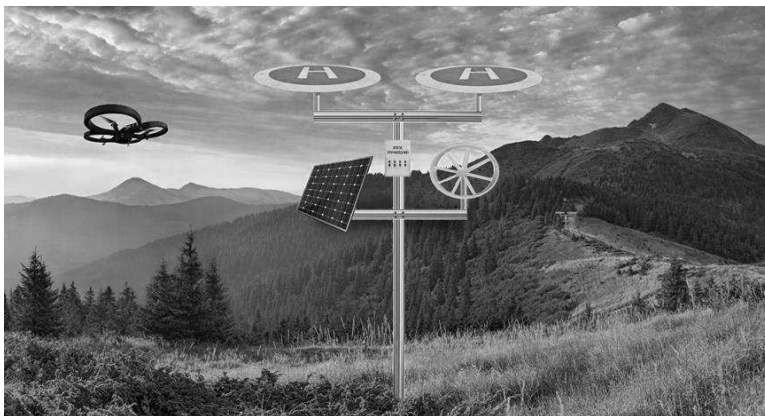
Рис. 1. Наземная зарядная станция с ветро-солнечной системой электропитания
