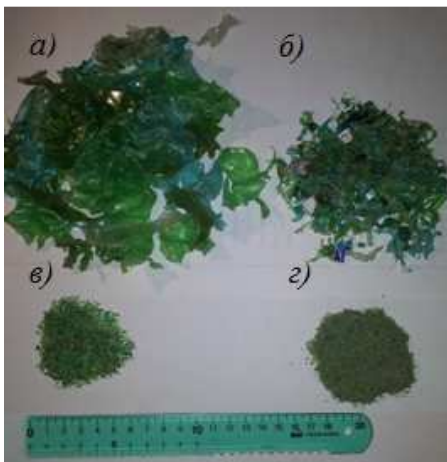
Рис. 4. Измельченный материал различного фракционного состава: а) d > 10 мм; б) 10 \text{ мм} \geq d > 2 мм; в) 2 \text{ мм} \geq d > 1 мм; г) d \leq 1 мм
