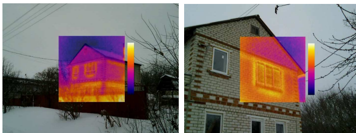
Рис. 2. Тепловые потери частного дома
