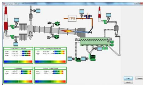
Система предназначена для сбора в режиме реального времени информации о состоянии объекта через существующую базу данных, оценки режимов функционирования и предложения оператору печи вариантов действий для наиболее эффективного управления. Части системы сданы в промышленную эксплуатацию на ЗАО «Осколцемент» и ОАО «Себряковцемент». С фирмой AdAstra (производитель систем автоматизации, г.Москва) заключен договор о намерениях по внедрению предлагаемых алгоритмов в SCADA-систему TraceMode.
